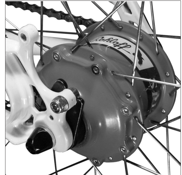
Rohloff SPEEDHUB 500/14 CC OEM2 montiert mit Stützschaube
