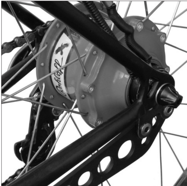
Rohloff SPEEDHUB 500/14 CC montiert mit langer Drehmomentstütze
