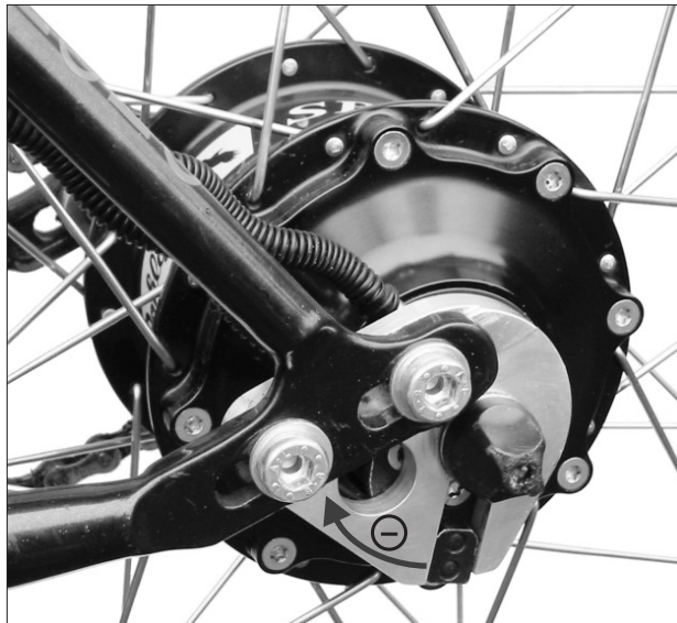
Rohloff SPEEDHUB 500/14 CC OEM montiert in Rahmen mit verschiebbaren Rohloff OEM Ausfallenden
