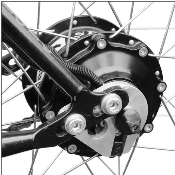
Rohloff SPEEDHUB 500/14 CC OEM montiert in Rahmen mit verschiebbaren Rohloff OEM Ausfallenden
